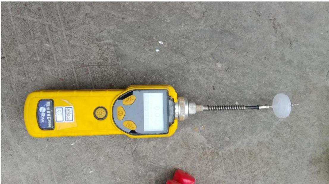
图 9.4.2-2 PID 快速检测设备
